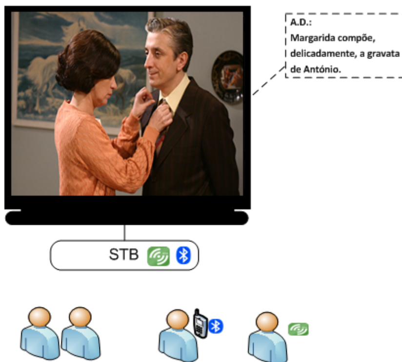
Figura 5 – Identificação de utilizadores num sistema de áudio descrição interactivo através de RFID e Bluetooth
